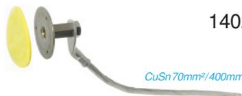
140245 Erdungsfestpunkt M16 für **Trafoerdung** über 1kV (Anschluss des Ringpotenzialausgleichs von Starkstrom-Erdungsanlage), M16x20mm-Anschlussgewinde für höhere Strombelastung **11kA** (1s≤300°C) bei 50Hz, **Cu-Seil 70mm<sup>2</sup>** (D=10,5mm) galv. verzinkt, L=400mm, verbunden mit Winkel-Kabelschuh (45°) mit VA4-Platte D=90mm, mit 3 Nagellöchern d=4,5mm, Körper SW22, 0,60kg
