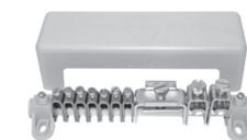
140278 PAS FL30x5/RD8-10/Ms/D mit Kunststoffabdeckung für Hauptpotenzialausgleich, Messing blank, 1x 30x5mm oder d=8-10mm, 1x d=8-12mm, 7x 25mm<sup>2</sup> ein-/mehrdr. od.16mm<sup>2</sup> feindr., Messing, k.LW
