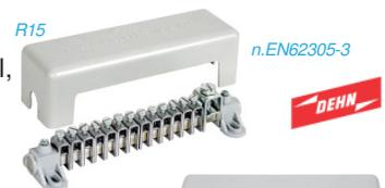
140112 PAS 40x4/Ms/D Reihenklemmensystem für Haupt- und Blitzschutzpotenzialausgleich, **Messing galv. verzinkt** 100mm<sup>2</sup>, mit plombierbarem Deckel, grau, Anschlüsse: 7x 2,5-16mm<sup>2</sup>, 2x 16-95mm<sup>2</sup> bzw. RD 8-10mm, **1x EBE-40x5mm**, L=202mm, H, (563040), 0,48kg
