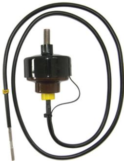
190933 **ÜA/ZNO-69841** Zinkoxidvaristor In 10kA, I max.15kA, 280V AC, mit gelber Isolierkappe, 1m isolierte Anschlussleitung Cu-6mm<sup>2</sup> mit Abwurfsicherung, Schraubbolzen M8x17,5, Netz NÖ, Freileitung etc., [46020000](#), VE 10, 0,20kg
