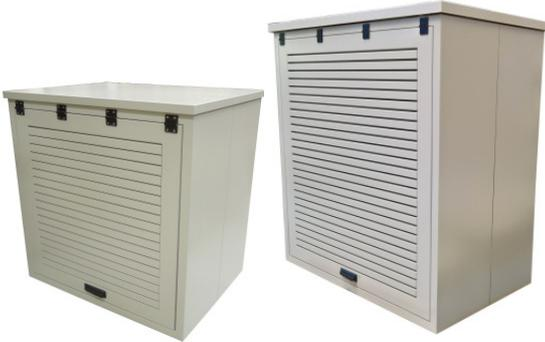
aus AlMg3, kunststoffbeschichtet in RAL7032, IP43, stochersicher, mit Lüftungsöffnungen in Türen und im Dachbereich, Insektenschutzgitter hinter Lüftungsöffnungen in den Türen, Kabelabfangschienen in den Seitenwänden, beidseitig Flügeltüren (nach oben öffnend) mit Gasdruckfedern, inkl. Schwenkhebelverschluss für den Einbau eines Profil-Halbzylinders, mit Erdungsanschluss, unten offen, vorbereitet für die Montage auf einem Betonfundament
